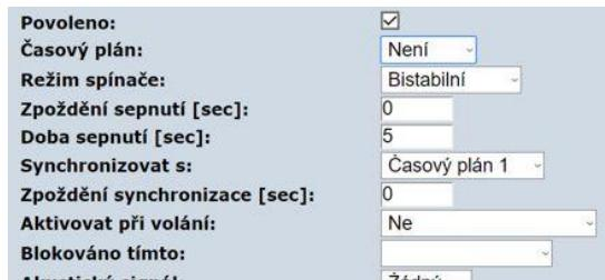
Pozn. Spínač je sepnutý v nastavených intervalech, mimo tyto intervaly je rozepnutý. Např. v pondělí je spínač sepnutý od 8:00 do 15:00.
