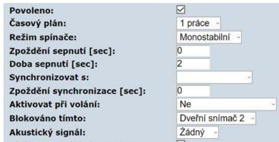
Pozn. Pokud je takto nastaven spínač 1, tak spínač 1 lze sepnout jen v intervalech daných časovým plánem „práce“ a pouze pokud je vstup dveřního senzoru spojený (sepnutý dveřní kontakt)
